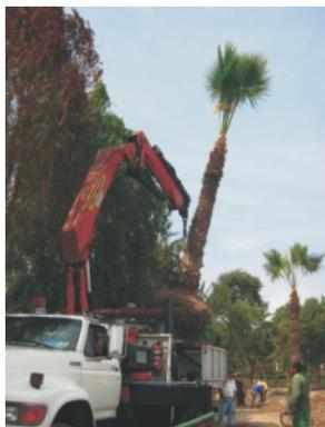
Fig. 5. Traslado de palmeras en la carrocería del vehículo con la pluma hidráulica.
