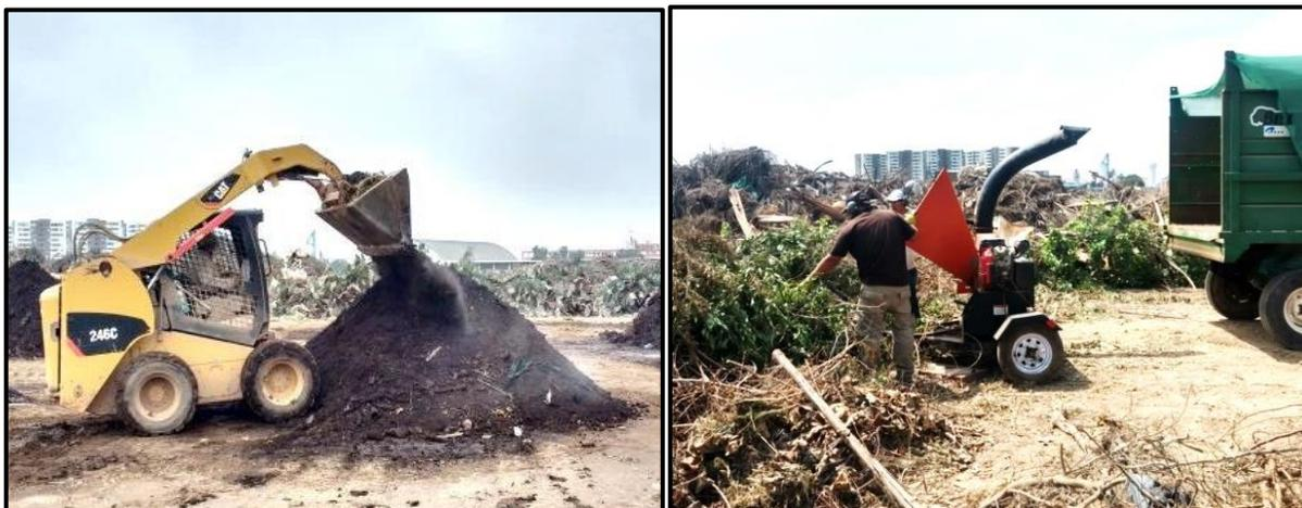
Imagen N°21. Mini cargador (bobcat) utilizado para la instalación y volteo de las pilas
