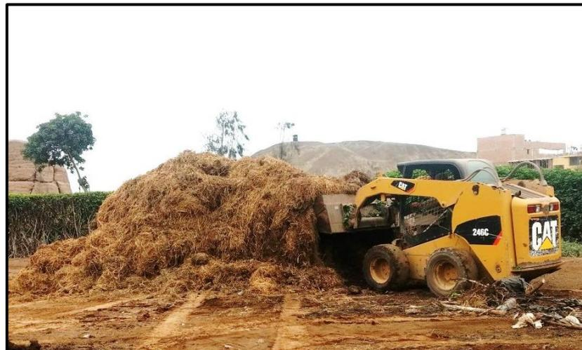
Imagen N°49. Volteo de pilas de pre-compost
