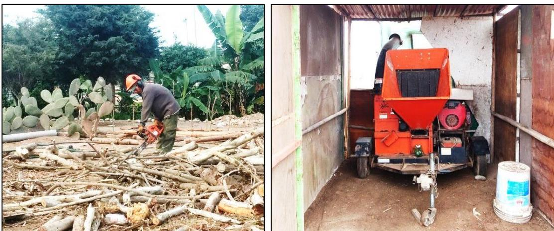
Imagen N°32 y 33. Uso de motosierra y Chipeadora para la producción de chips
